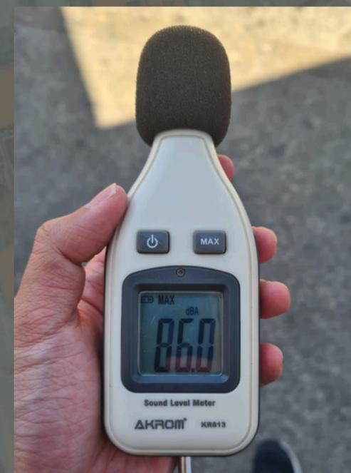
Sonômetro utilizado nas medições
